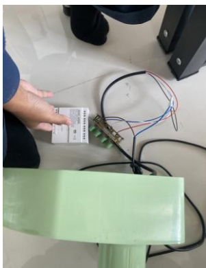
ภาพที่ 3.2 แกะฝาครอบด้านล่างของพัดลมเพื่อ ต่อสายพัดลมเข้ากับตัว ESP32
