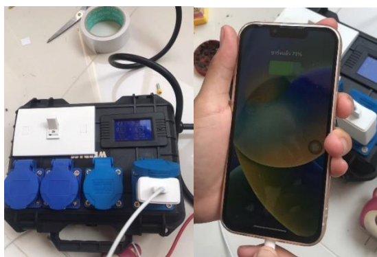
ภาพที่ 3.6 ทดลองการทำงานของสมาร์ตปลั๊ก
