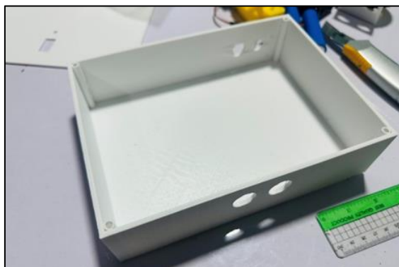
ภาพที่ 3.5 ชิ้นงานได้จากการป็นขึ้นด้วยเครื่อง 3D Printer
