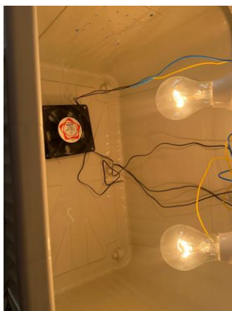
ภาพที่ 3.5 ติดหลอดไฟและทดลองเปิดพัดลม
