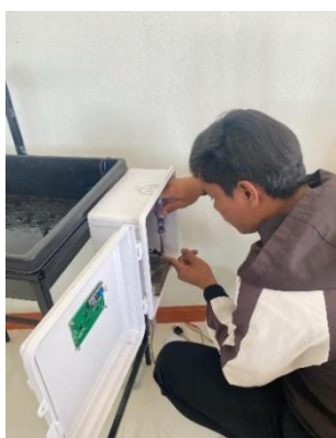
ภาพที่ 3.4 ติดตั้งแผงวงจร
