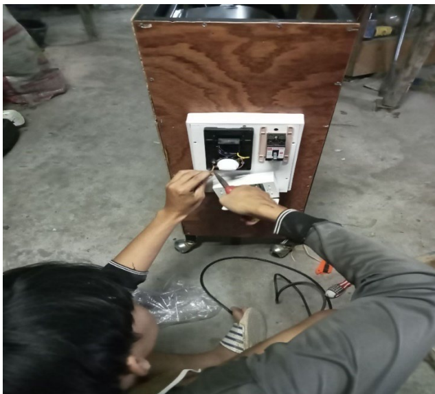
รูปภาพที่ 7 แสดงภาพการต่อสายพัดลมเข้าตัวปรับระดับ
