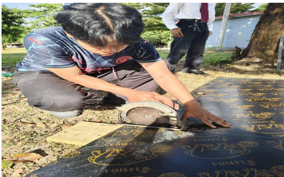
รูปภาพที่ 7 แสดงนำกระดานไม้อัดมาตัดเพื่อประกอบกับเหล็กที่เชื่อม
