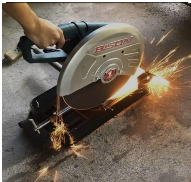
รูปภาพที่ 4 แสดงการนำเหล็กมาตัดเพื่อขึ้นชิ้นงาน
