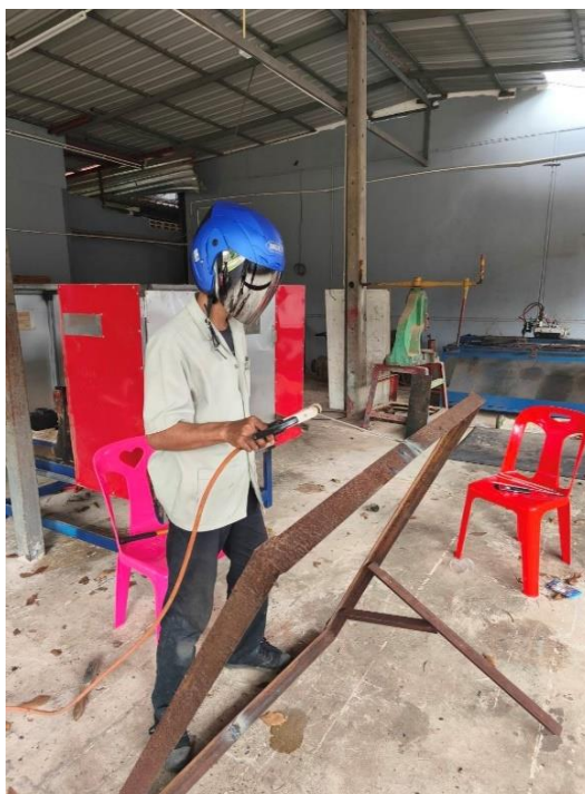
รูปภาพที่ 5 แสดงการเชื่อมเหล็กเพื่อขึ้นโครงชิ้นงาน
