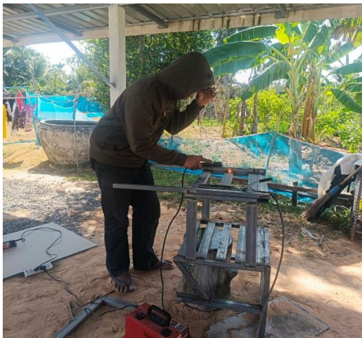
รูปภาพที่ 3 แสดงรูปภาพของการนำเหล็กกล่องมาเชื่อมโครงเหล็ก
