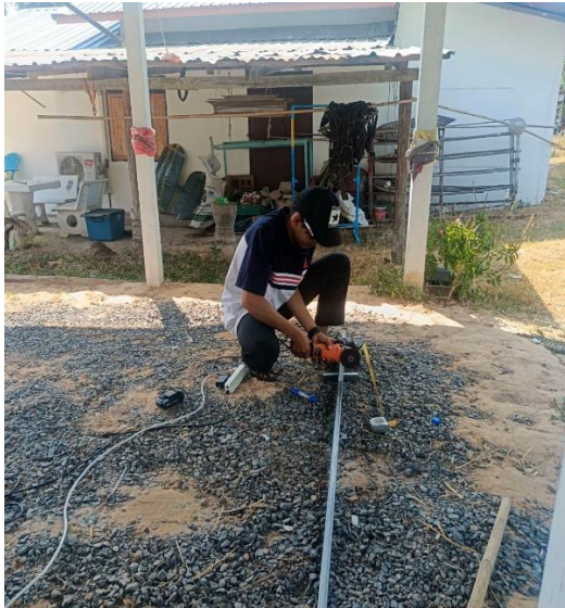
รูปภาพที่ 3 แสดงรูปภาพของการนำเหล็กกล่องขนาด 1/2 นิ้ว มาตัดเพื่อทำชิ้นงาน
