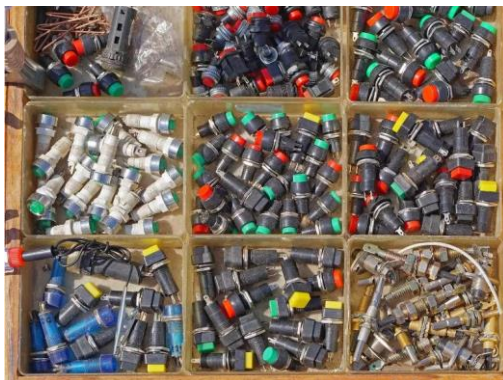
ภาพที่ 2.10 สวิตช์กดติดกดดับ
