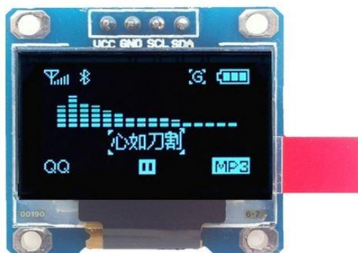
ภาพที่ 2.9 โมดูลจอแสดงผล OLED ขนาด 0.96 นิ้ว
