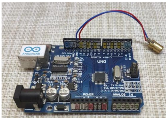
ภาพที่ 2.6 การต่อวงจร Arduino กับไฟเลเซอร์ ที่มา : https://www.allnewstep.com/product/
