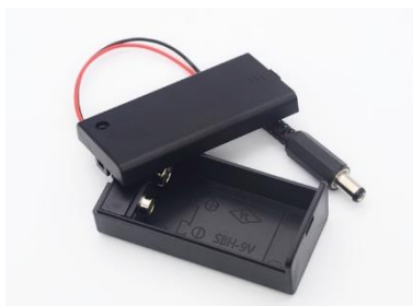
ภาพที่ 2.12 รางถ่าน 9 โวลต์แบบ 2 ก้อน
