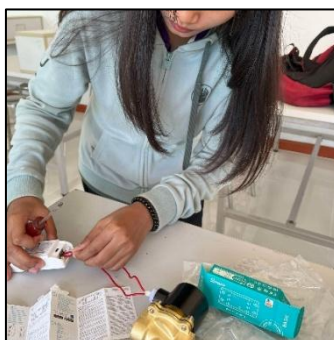
ภาพที่ 3.2 ต่อโซลีนอยวาล์วเข้ากับ Output ของ Sonoff
