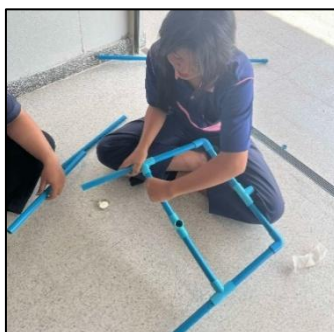
ภาพที่ 3.7 ต่อท่อ PVC ที่ใช้เป็นฐานของตัวสปริงเกอร์
