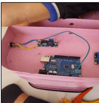
ภาพที่ 3.4 เจาะรูบนถังขยะเพื่อติดตั้งอุปกรณ์
